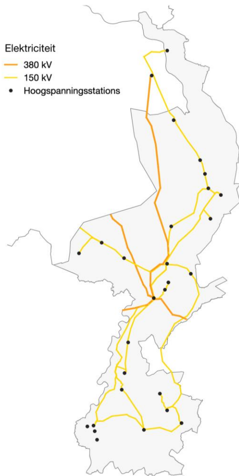
Figuur 1 - Hoogspanningsnet in Limburg met 380 kV-verbindingen (rood) en 150 kV-verbindingen (geel)
