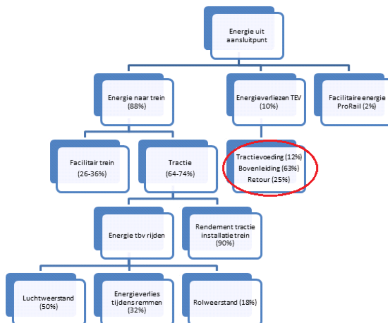
Figuur 3 - Locatie van energiebesparing in de keten: Onderstations bijplaatsen
