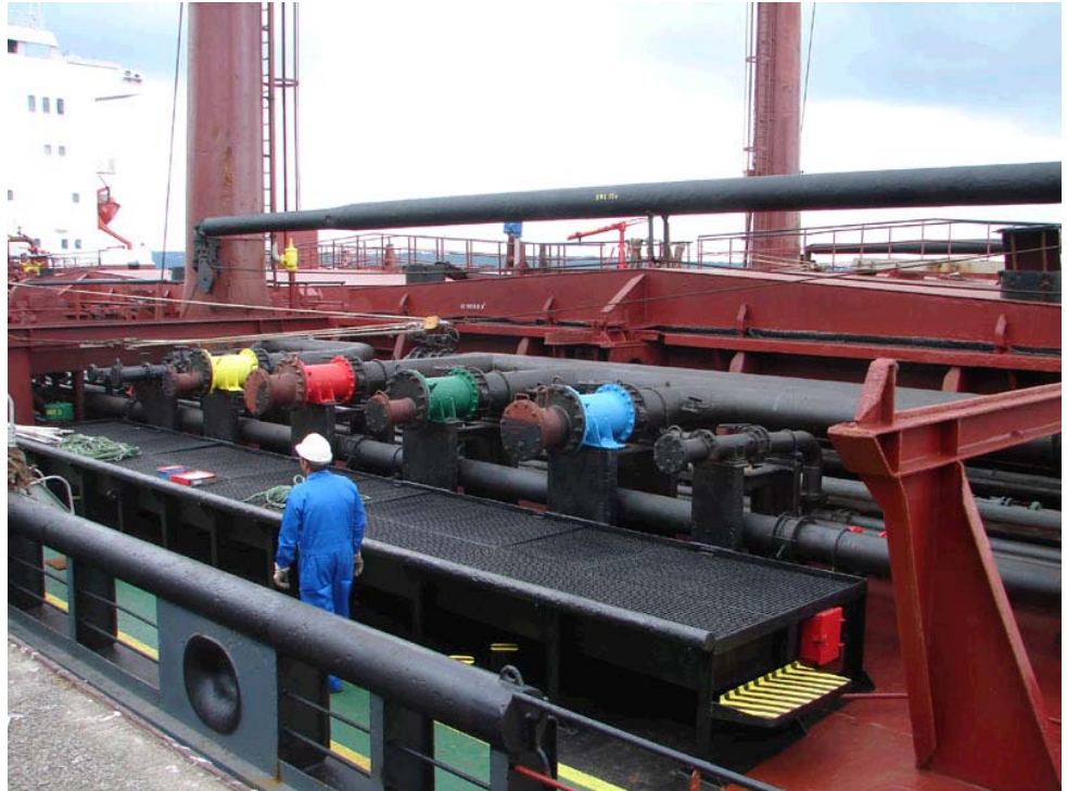
Figuur 7 Aansluitingen op een schip voor het verpompen van aardolieproducten
