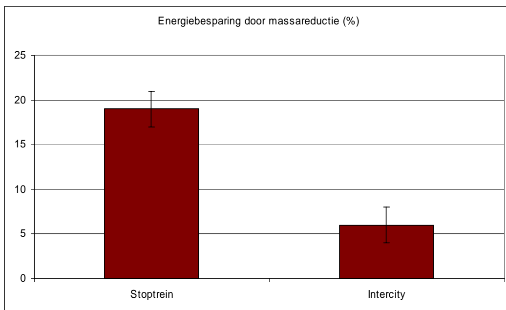
Figuur 19 Energiebesparing trein door massareductie
