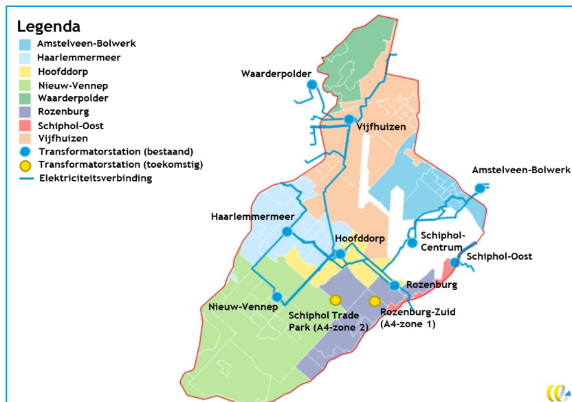
Figuur 20 - Voorzieningsgebieden per transformatorstation van Liander
