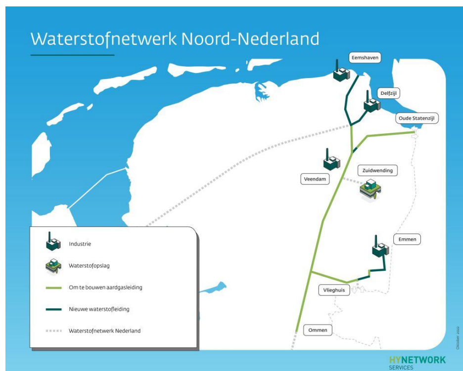
Figuur 4 - Voorlopig ontwerp waterstofnetwerk Noord-Nederland
